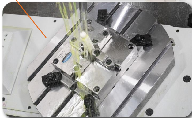
五軸同時制御の球体加工
